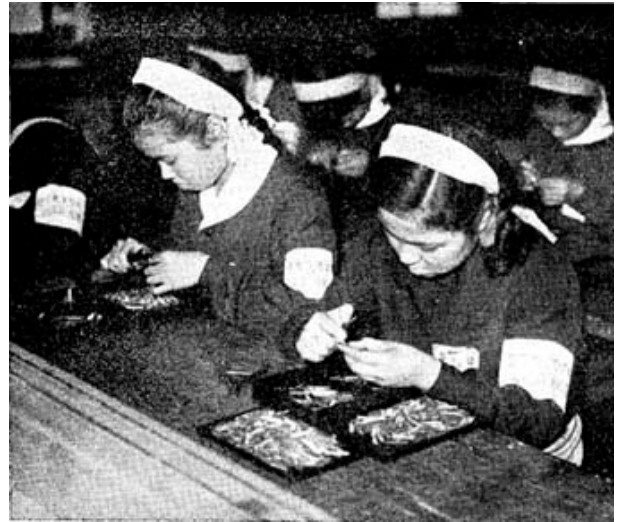
第2図 ゲージに合わせて生グリッドの足切りと目外ずしをしているところ
