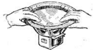
第75図 コーン紙を軽く動かしてみる
